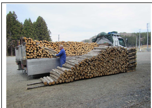
原木は地面につけないよう枕木を使用
