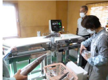
(非破壊検査機による検査状況 (タケノコ))
