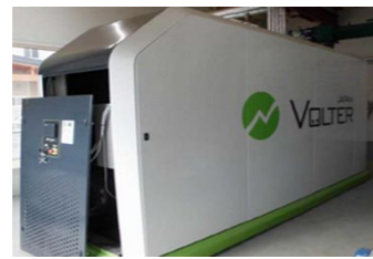
超小型木質バイオマス発電施設
