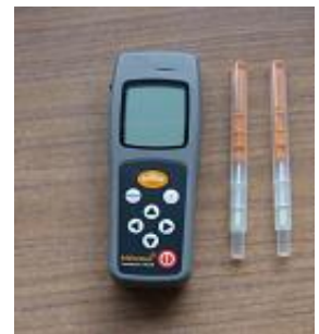
測定に使用する小型ルミノメーターと、専用の測定チューブ
