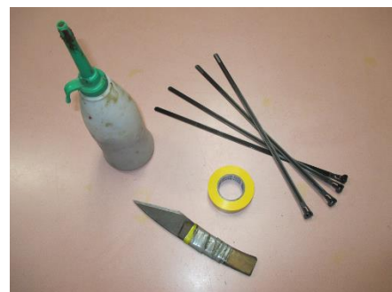
図11 ジョイントに必要な道具(癒合剤は塗布しやすいボトルに入れ替える)
