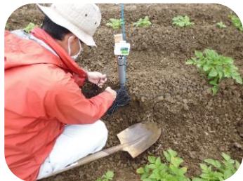
パレイシヨほ場での 土壌水分センサー設置作業
