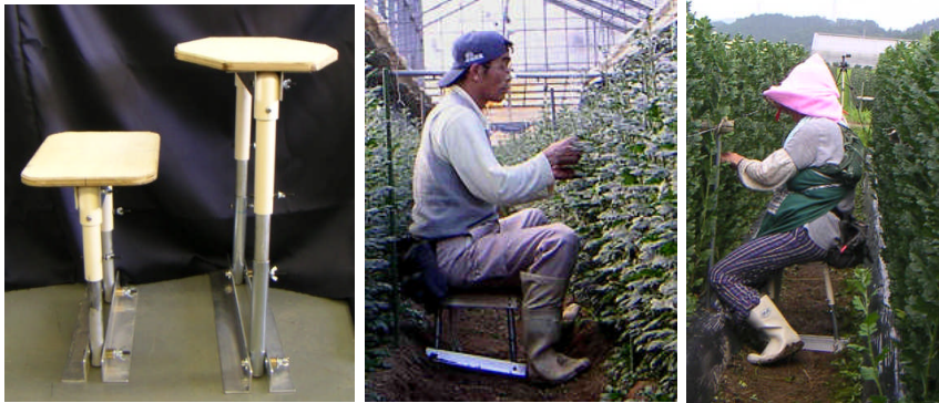
図1 作業補助イス（高いタイプと低いタイプ），使用状況
