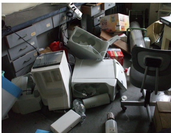
5階検査室 HPLC 落下破損
