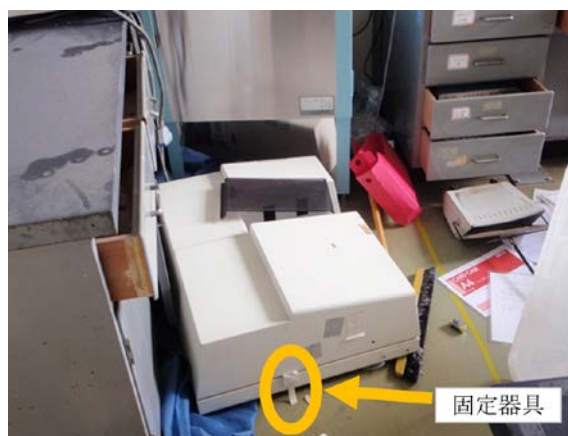
固定していたにもかかわらず机から落下破損した分光光度計 (4階)
