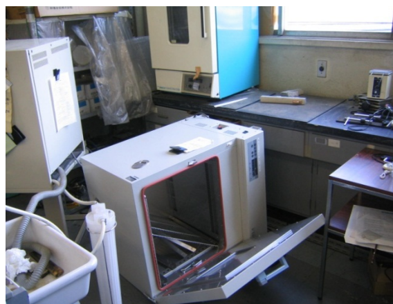
2階分析室 定温乾燥機落下破損
