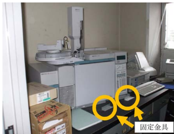
金具により落下は回避したが破損した GC/MS (4階)
