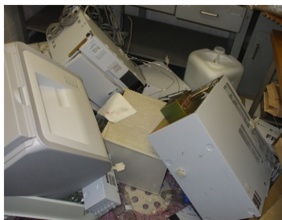
5階検査室 HPLC 落下破損
