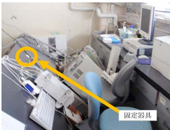
固定器具からも脱落し、さらに机も転倒机から落下破損した GC/MS (3階)
