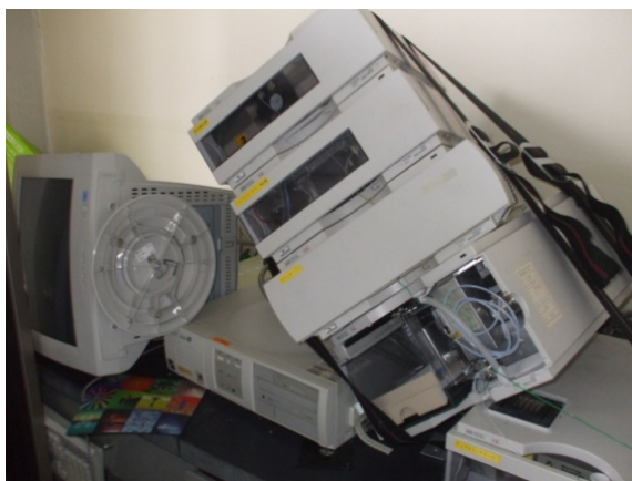
3階精密天秤室 HPLC 破損
