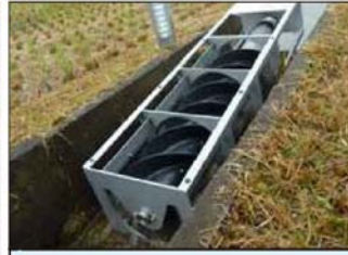
農業用水路（U字溝）に置くだけで発電でき、移動も可能。電力量は3～10Wあり、街灯や獣害防止用電柵などに利用できる。
