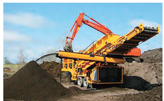
写真 稼働中のスタースクリーン
