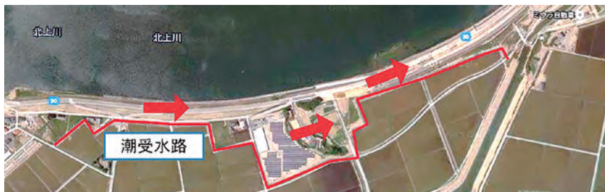
図 石巻市大川地区針岡工区（北上川右岸）に追加整備された潮受水路
