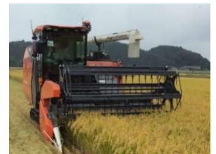
食味・収量センサ付き自動走行コンバインによる収穫作業
