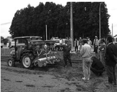
畝たて同時施肥機を実演しました。JA加美よつば キャベツ現地検討会（7月20日）
