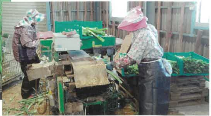
長ねぎ根葉切り皮剥機による調製作業（大崎市）
