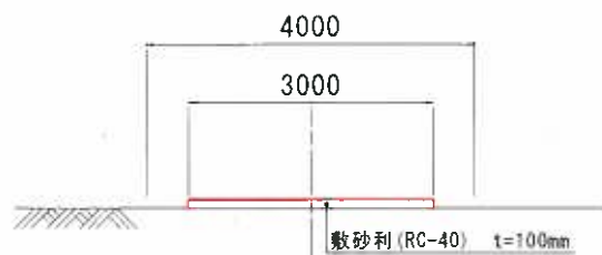
仮設道路標準断面図 B-B断面
