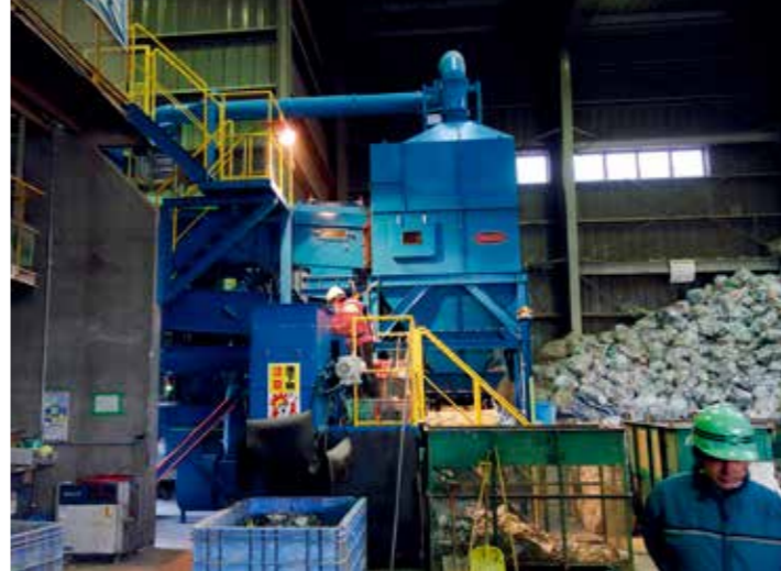
廃棄物高精度選別機(手選別では分別できなかったプラスチックなどを高精度に選別できる装置を導入してリサイクル量を増やし、最終処分量を削減)
