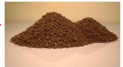
注 含水比が 75%程度の浄水発生土の天日乾燥処理を行い、含水比を 33%程度に下げること、国土交通省が策定する「建設汚泥マニュアル」の第 3 種処理土として再利用（販売）を行っています。
