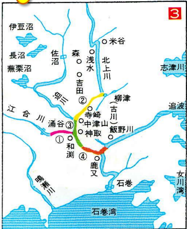
①元和2年江合川と迫川を合流 (1616)(短台地峡の開削) ②元和3年~6年 (1617~1620) 柳津~猪岡短台開削 麻崎村小麻に締切堤防を築く ③神取山を迂回する河道の掘削 (人口狭窄部をつくる) ④河道拡幅工事 (元和7~8年) (1621~1622)
