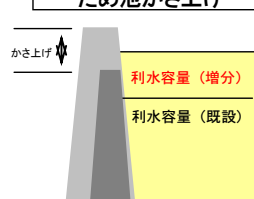
ため池かさ上げ
