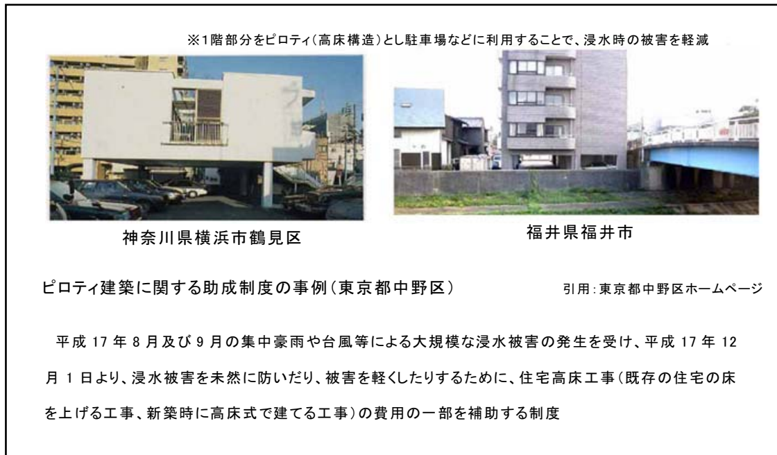
図 4-20 ピロティ建築の事例
