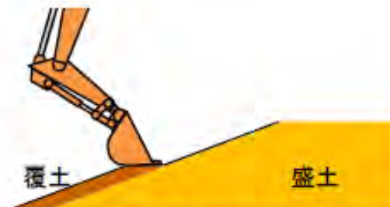
土砂を垂直に押さえるように施工
