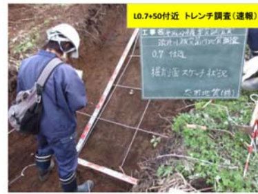
トレンチ掘削 スケッチ 観察箇所
