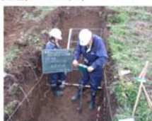
ポータブルコーン貫入試験状況
