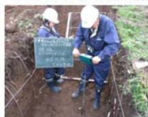
ポータブルコーン貫入試験状況
