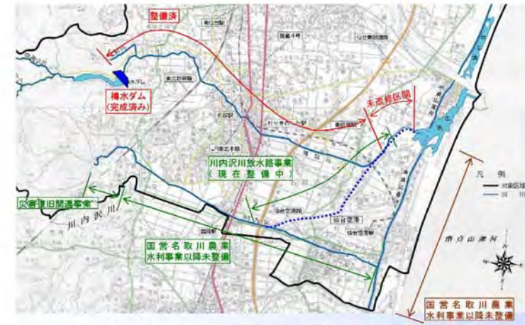
図1-15 増田川・川内沢川・南貞山運河の整備状況
