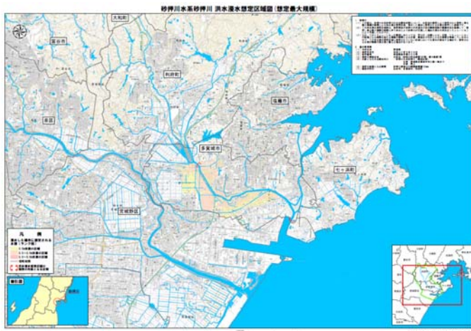
砂押川浸水想定区域図 (想定し得る最大規模 723mm/日) (平成 30 年 5 月 29 日公表)
