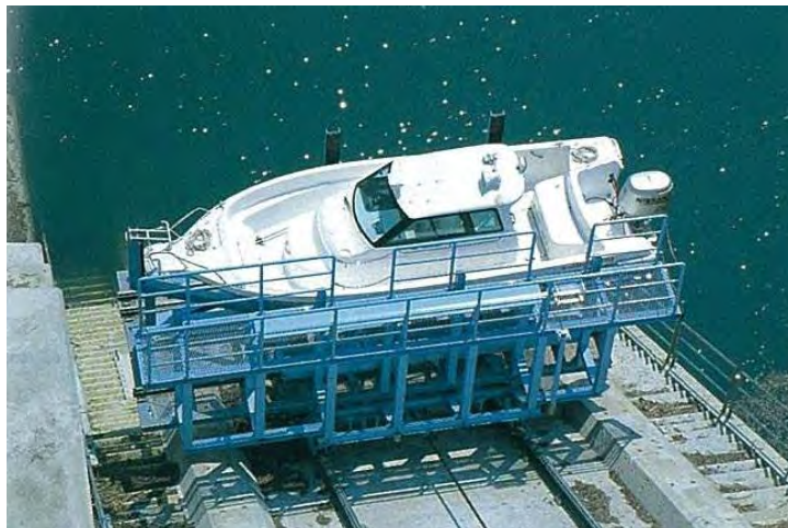
係船設備(他ダム事例)
