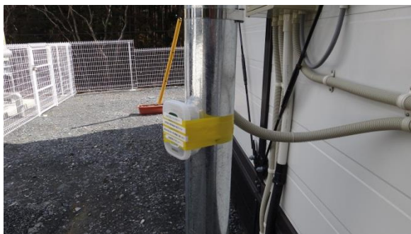
写真1 積算線量計の据え付け方法 高白地区仮設住宅(H24.3撮影)
