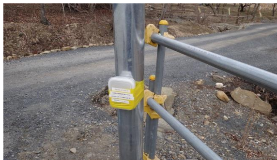
写真2 積算線量計の据え付け方法 大石原地区仮設住宅(H24.3撮影)
