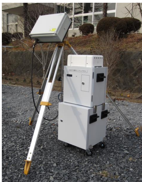
図 2 可搬型モニタリングポスト
