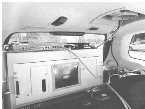
図3 車両内部（線量率測定装置）
