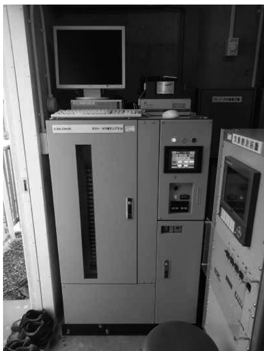
図1 ゲルマニウム半導体検出器ダストヨウ素モニタ測定部
