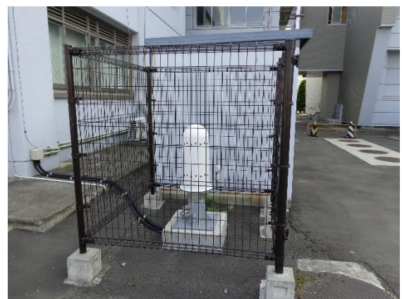
図 45：放射線量を測定するモニタリングポスト 画像出典：宮城県
