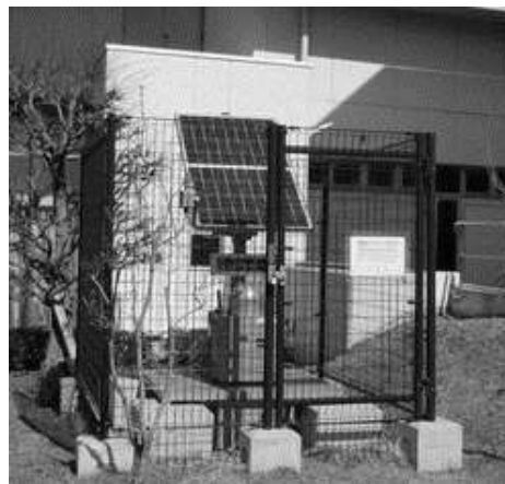
図 43：放射線量を測定するモニタリングポスト 画像出典：美里町
