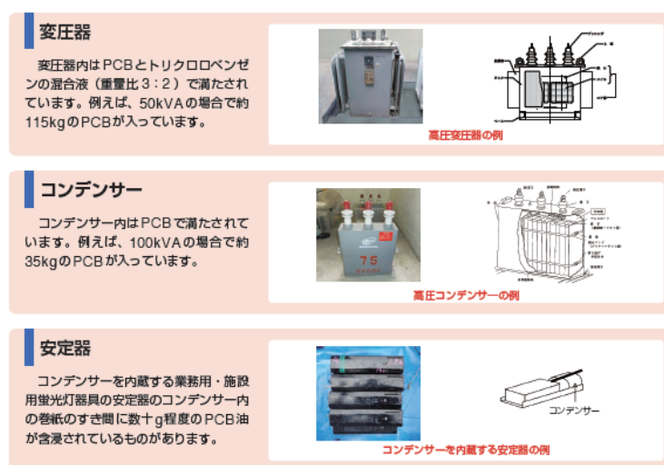
図 2 2 : 高濃度 PCB 廃棄物 (PCB が使用された代表的な電気機器等) 出典 : 環境省
