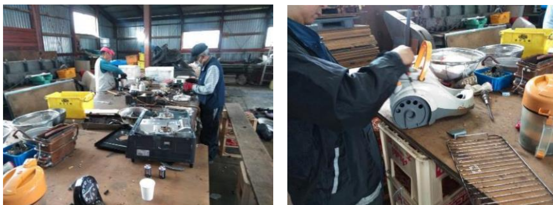
図 3-34 手解体・選別作業の様子（県指定 11 品目以外）
