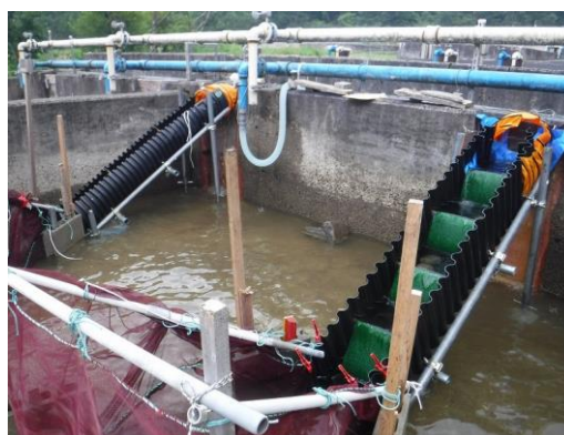
図2 場内試験の様子（奥が円形型ハーフパイプ式簡易魚道）
