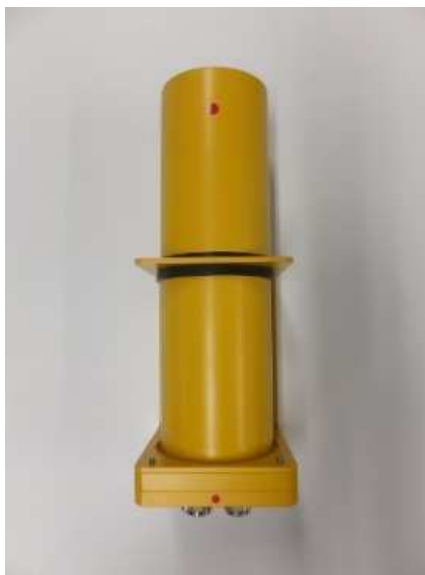
放射線モニタ (放射線量を検出する箇所)
