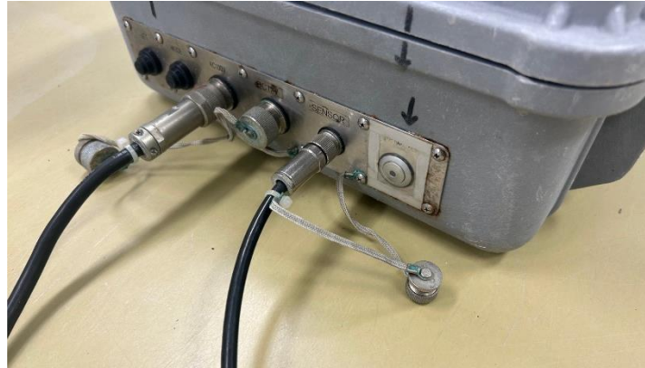
図2 直読式総合水質計の全体図と破断箇所
