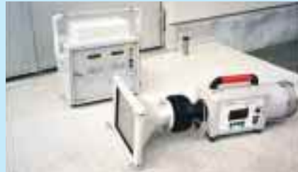
可搬型モニタリングポスト(左)ダストサンプラー(右)
