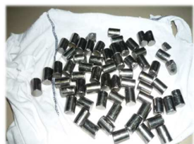
損傷写真(コロ)
