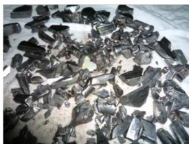
損傷写真(内外輪)
