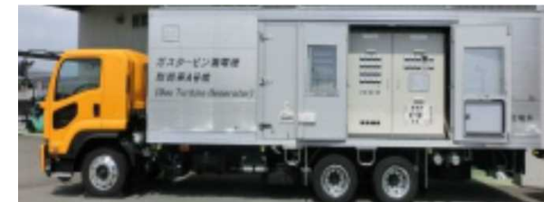
ガスタービン発電機
