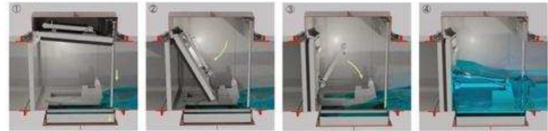
止水ダンパの設置(新設:壁貫通ダクト)
