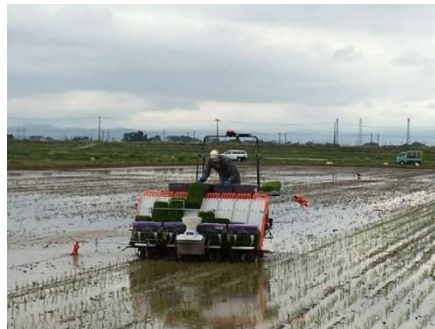
▲自動運転で走行中のオペレーター1人で苗補充が可能
