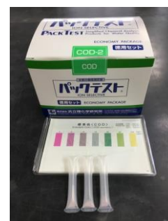
COD簡易比色キット (株)共立理化学研究所製 バックテスト KR-COD-2
