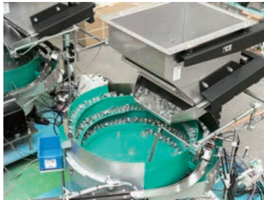
同社が設計製造したパーツフィード。ドラムの中で小さな部品が自動的に整列されていく
