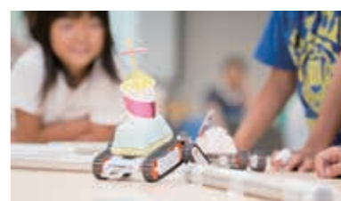
テスト走行の様子。4本のクローラーを駆使して障害物を乗り越えた
