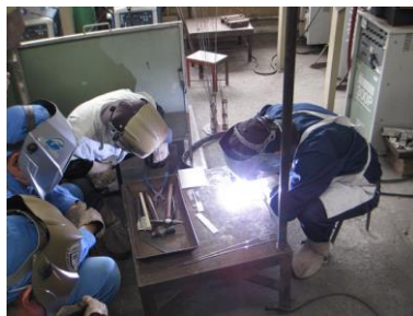
ステンレス溶接作業
