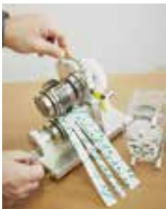
プラスチックフィルムなどを細い幅で加工するための装置をミニチュアサイズにした新商品「ラボユニットシリーズ」は、生産機を使うよりコストと時間をかけずに実験ができる
