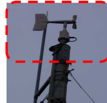
気象観測装置 (風向・風速計, 感雨計※, 雨雪量計※)
