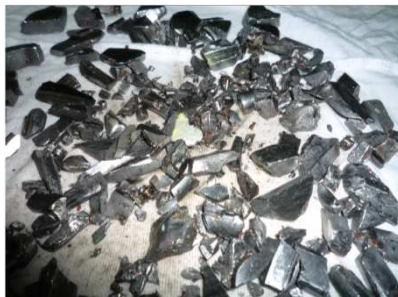
損傷写真(内外輪)
