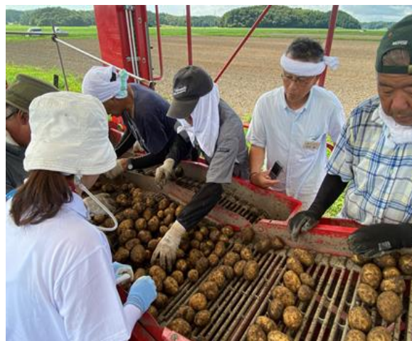
ポテトハーベスタ: グリメ社SE75-20による堀取り作業と機上選別の様子
