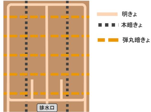
図11 暗きよの施工例
