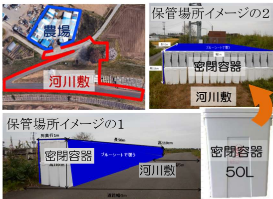
図2 河川敷地を活用した焼却用密閉容器の保管状況
