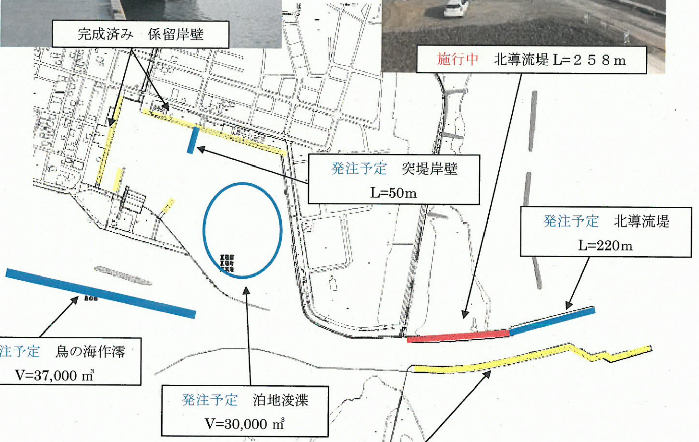
今回完成 南導流堤 L=645m
