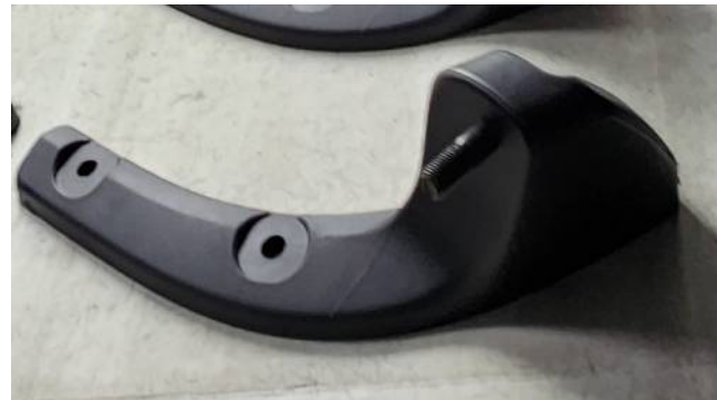
再度ミラーブラケットのボルト形状、バリの検査
